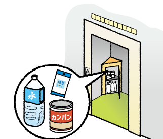
エレベーター閉じ込め 対策キャビネット
